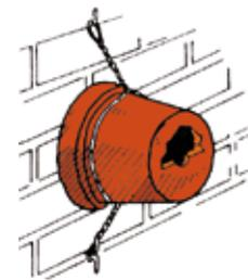
Fixer solidement le pot sur un mur ou sur une poutre
